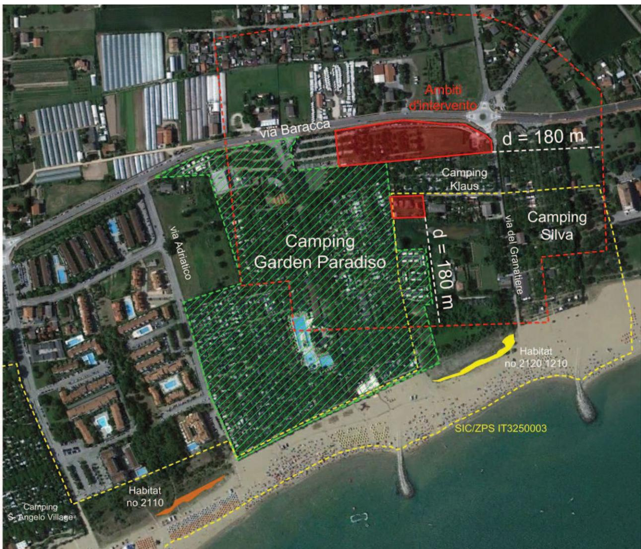
Figura 4-4: Distanza di interferenza potenziale per il vettore rumore (180 m - in rosso) per l'INTERVENTO DI INTERESSE PRIVATO (AMPLIAMENTO CAMPEGGIO)
