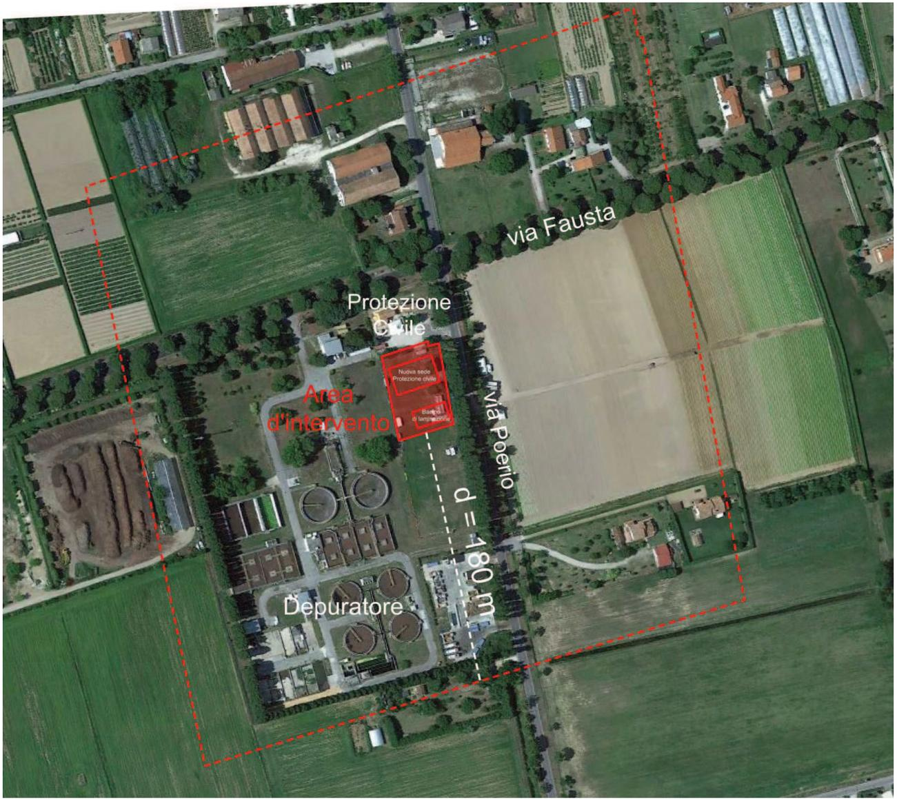
Figura 4-5: Distanza di interferenza potenziale per il vettore rumore (180 m - in rosso) per l'INTERVENTO DI INTERESSE PUBBLICO (NUOVA SEDE PROTEZIONE CIVILE)
